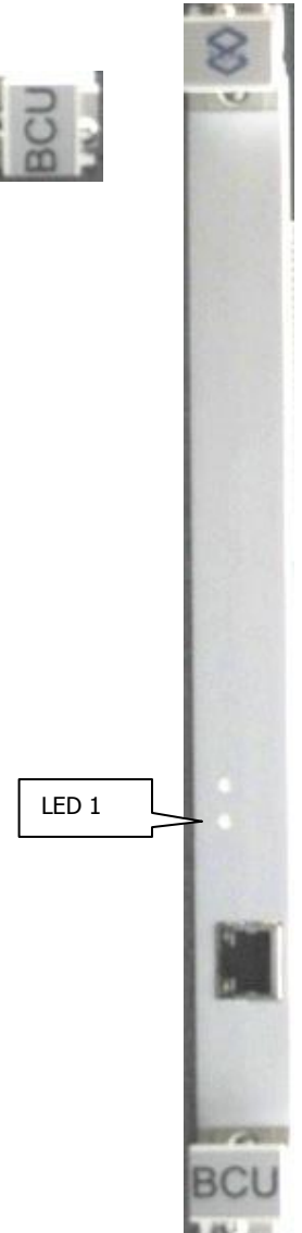
Abbildung 17: BCU (aufrechte Lage beim Einbau in 6HE Chassis)
