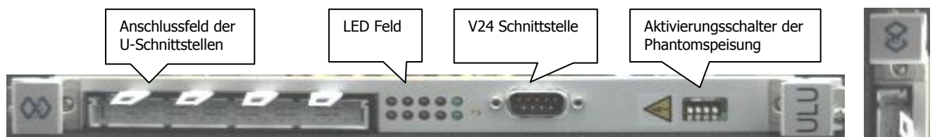
Abbildung 18: ULU (Seitenlage beim Einbau in 3HE Chassis)
