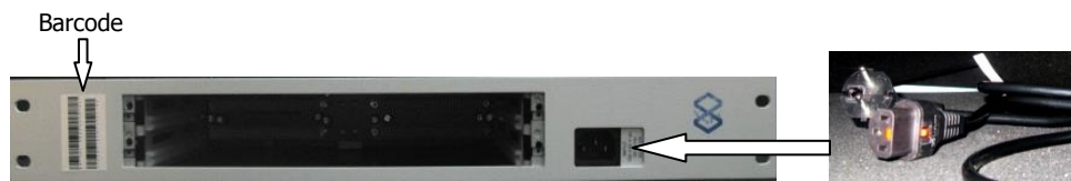
Abbildung 5: S5+ als 19" Chassis (1F5201)
