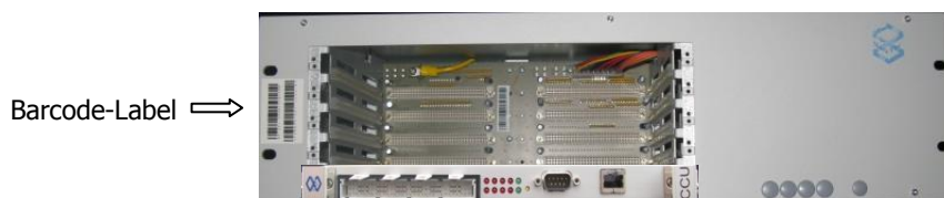
Abbildung 4: S6 ohne redundanzfähige Netzteile (1F5001S), bestückt mit einer CCU3
